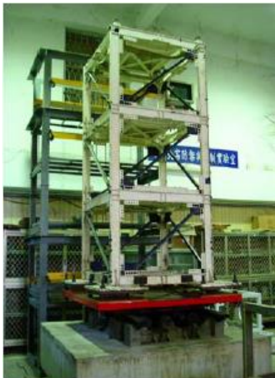
شکل ۸: آزمایش جداگر آونگی اصطکاکی شیاری سه‌گانه بر روی میز لرزه و زیر سازه ۳ طبقه (تسای ۲۰۰۹)
